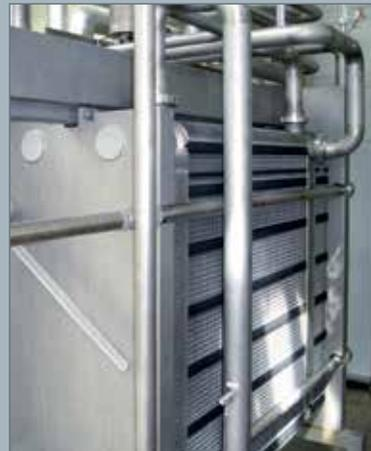
Plattenwärmeübertrager für die
