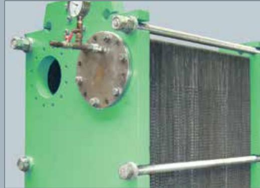
Druckprobe des regummierten Plattenwärmeübertragers
