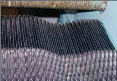
Plattenverschiebungen im zusammengespannten Zustand
