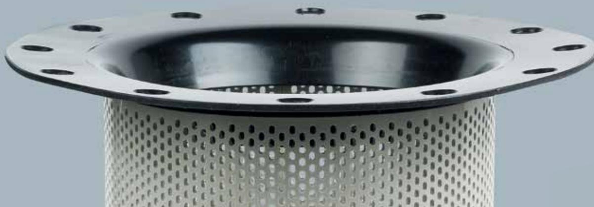
Beim klassischen Vorfilter oder Inline-Strainer handelt es sich um einfache Lochbleche aus Edelstahl, welche zu einem Zylinder verschweißt und je nach Längenvorgabe ein- oder zweiteilig ausgeführt werden. Die Einschränkung: Die Ausführung kann nur für den jeweiligen Kühler des Herstellers verwendet werden.
