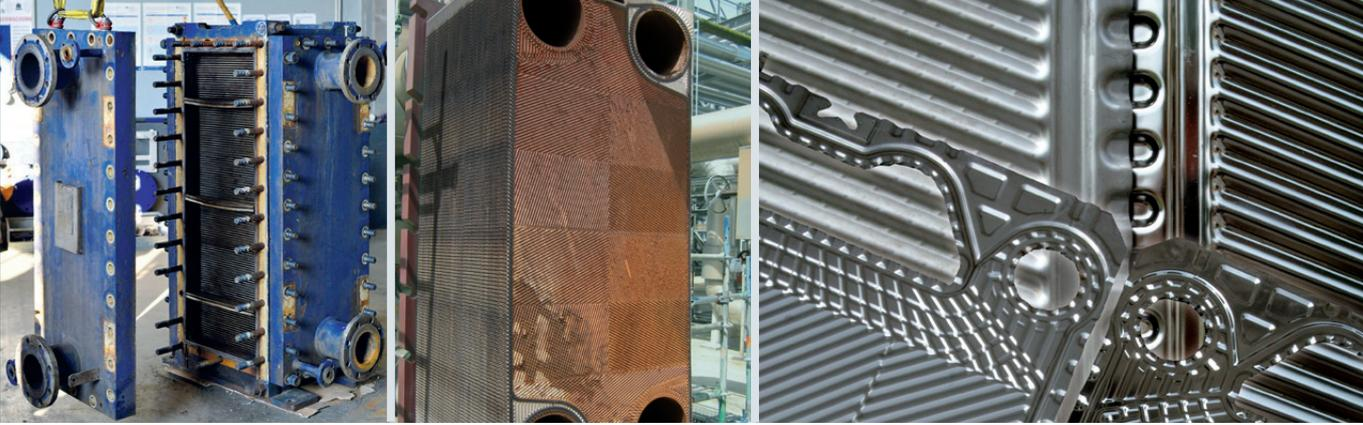
Um Produktionsstillstände zu minimieren, hat AKK Industrieservice ein Verfahren entwickelt, um Wärmetauscherplatten einer optimalen Rekonditionierung zu unterziehen.
